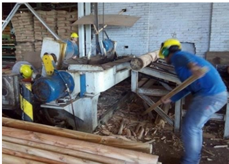
Imagen 1: Operario retirando manualmente meillos atascados uno a uno, así como los residuos del torno. Image 1: Operator manually removing cores one by one and veneer waste
